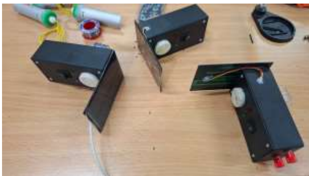
Gambar 6. Foto Alat Deteksi Banjir yang di Implementasikan
